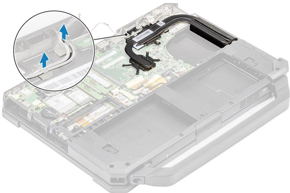
4. Retire os cinco parafusos M2.5\*5 [1] e os dois parafusos M1.6\*5 [2] do módulo térmico.
