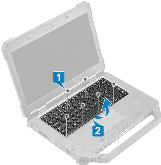
4. Deslize ligeiramente o teclado [1] na direção do painel tátil e vire-o ao contrário em posição inclinada sobre o painel do LCD [2].
