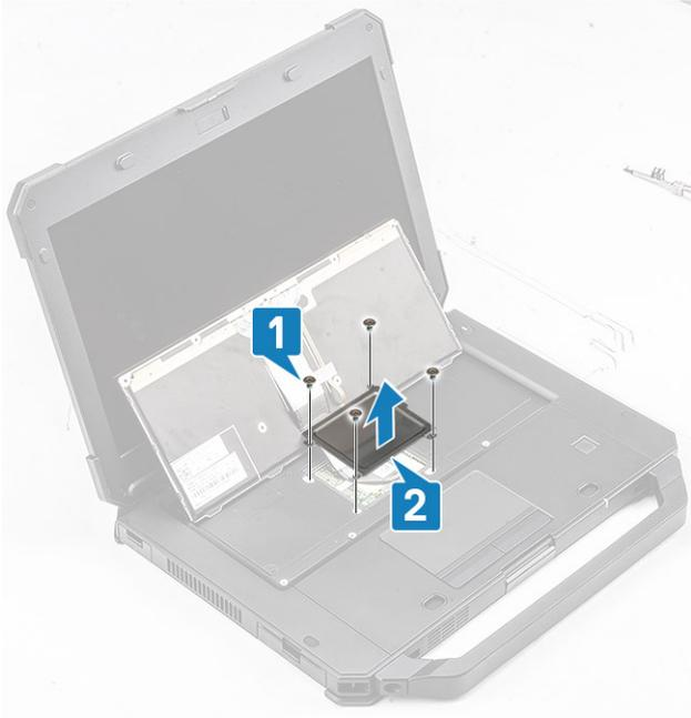
6. Retire a fita do teclado e o FPC retroiluminado [1] e desligue-o da placa de sistema [2].
