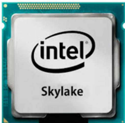
A placa gráfica Intel HD 620 (GT2) é uma unidade gráfica integrada, que pode ser encontrada em vários processadores ULV (tensão ultra baixa) da geração Skylake. Esta versão GT2 da GPU Skylake oferece 24 Unidades de execução (EU) com uma velocidade de até 1050 MHz (dependendo do modelo da CPU). Devido à falta de memória gráfica dedicada ou cache eDRAM, o HD 520 tem que aceder à memória principal (2 DDR3L-1600/DDR4-2133 de 64 bits).
