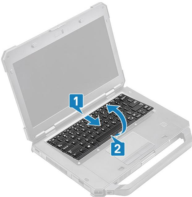
5. Retire os quatro parafusos M2\*3 [1] na tampa do teclado e retire-a do computador [2].
