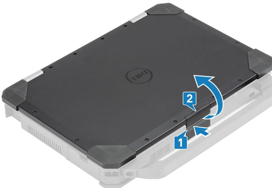
5. Segure a tampa do LCD num ângulo obtuso e empurre as tampas da dobradiça da extremidade traseira para retirá-la do computador.
