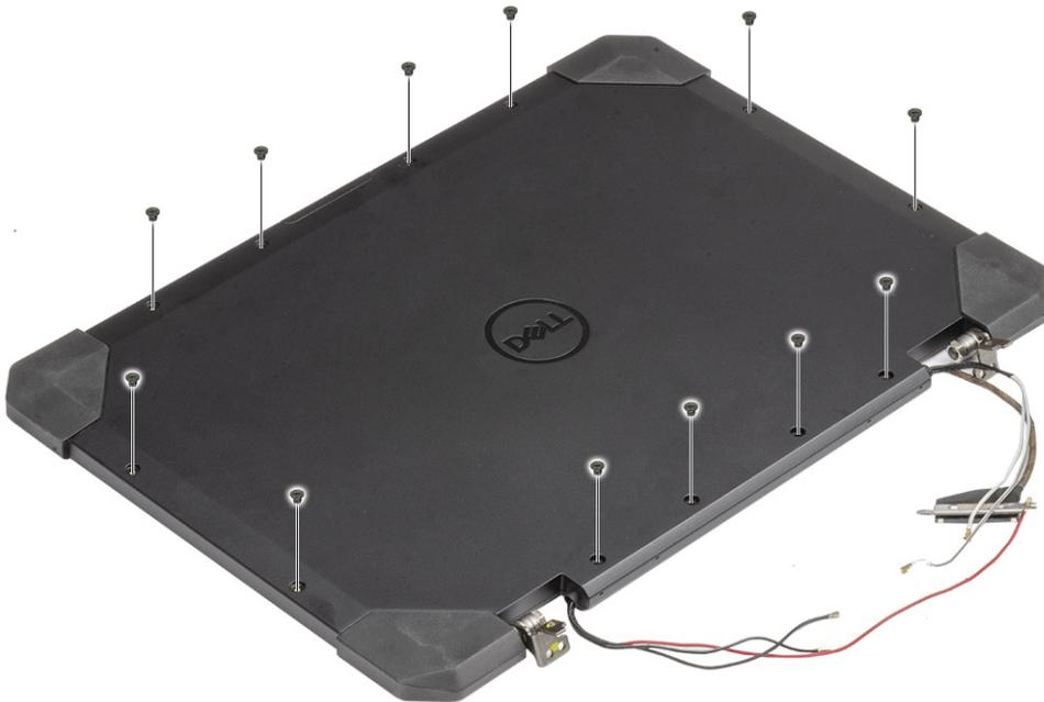
4. **AVISO:** A localização dos seguintes parafusos em resina de epóxi necessitam de atenção especial. É difícil remover estes parafusos e podem ocorrer danos durante o processo de remoção. Para evitar danos nos parafusos e nos plásticos circundantes, utilize a chave de parafusos correta para cada tipo de parafuso.
