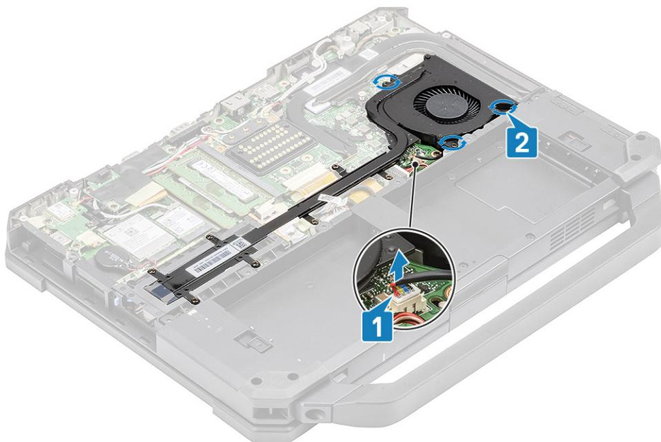
4. Desaperte os sete parafusos M2.5\*5 [1] do tubo do dissipador de calor e retire o conjunto do dissipador de calor do PCIe do computador [2].
